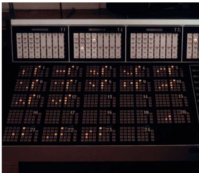
Ovan: Del av kontrollpanelen till EMS datorstyrda studio. Vi ser inställningar- na för de 24 tongeneratorerna. Ändringar gjordes med kopparborste direkt på panelen. Musik- och teaterbiblioteket, EMS fotoarkiv.
